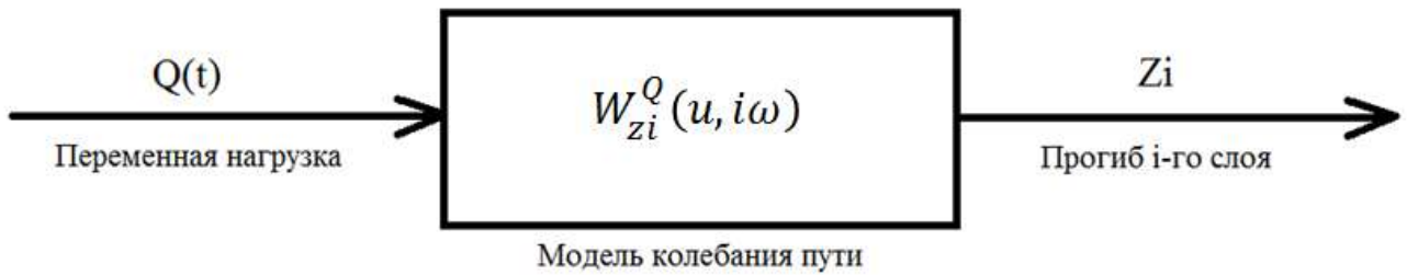
Рисунок 2.2 – Модель колебаний пути, как трехслойной балки, лежащей на многослойном модифицированном основании с входом по переменной динамической нагрузке Q(t) и выходом по прогибам слоев конструкции z_i
